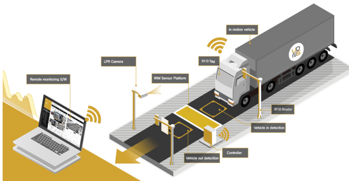
Figura 39 – Exemplu de Sistem de cantarire in miscare a greutatilor pe osie in cazul transporturilor grele
