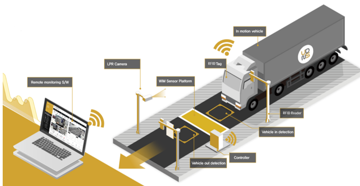
Figura 30 – Exemplu de Sistem de cântărire în mișcare a greutăților pe osie în cazul transporturilor grele
