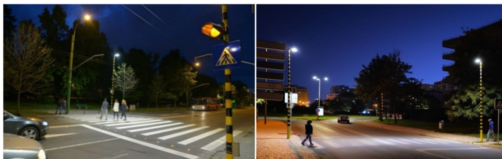
Figura 44 – Exemple de iluminat asimetric implementate
